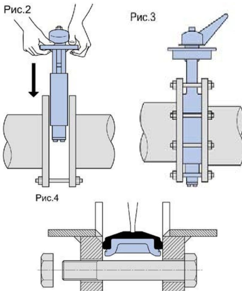
3.14 При установке затворов с приводом во избежание деформации горловины затвора и уменьшения вибрации затвора и трубы обеспечьте дополнительное крепление затвора.
